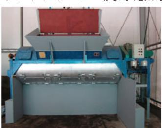
畜産排出物や産業排出物の有機物・鉱物質・土などを短時間で効率よく、ムラなく混合すると共に、近赤パワーで乾燥させ発酵を促進する機械です。
